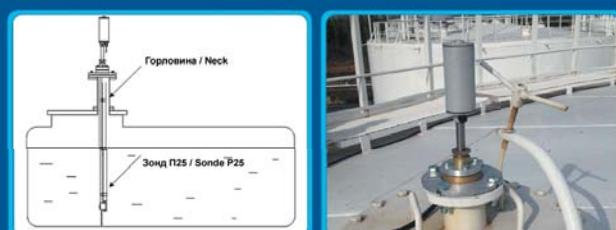
**Схема и фото установки преобразователей П25 и П25Т
