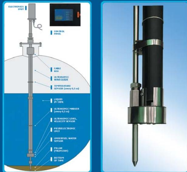
**Конструкция зонда П25 (длина более 5 м - составной зонд)
