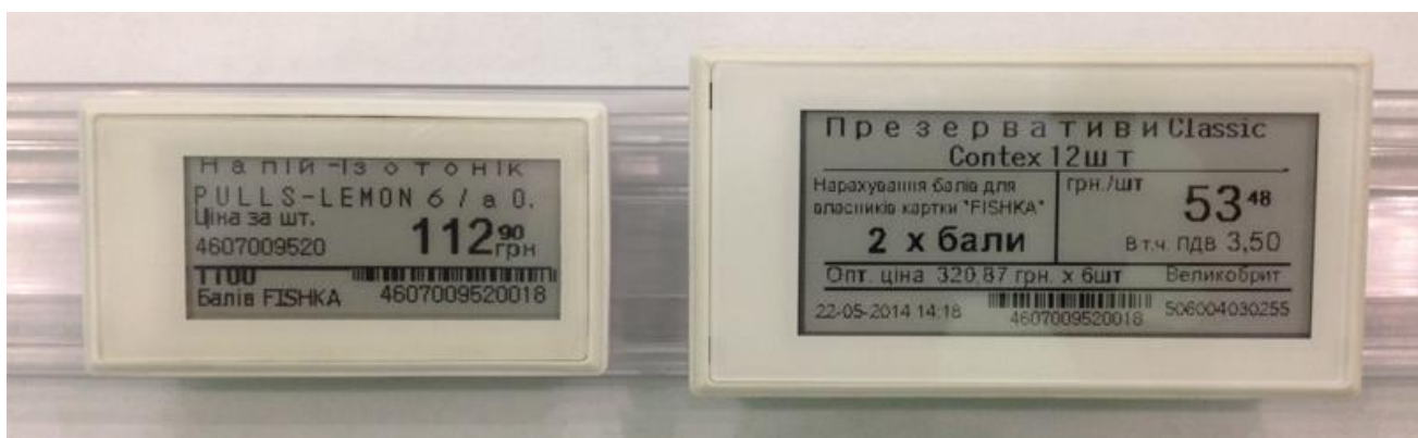
Рисунок 4. Размеры экранов предлагаемых ценников: 48x20, 66x28
